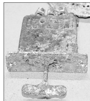
Der Handstarter des Jumo 004, der Riedelanlasser, mit dem Griff zum Ziehen der Schnur zum Starten des Motors.
