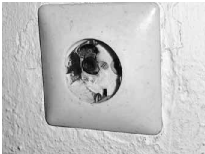
Verschmorte Steckdose im Kirchenschiff
